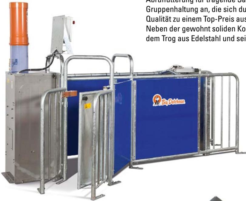
**Call-Inn** besticht durch eine hohe Funktionssicherheit und die genaue Ausdosierung des Futters. Der neue elektro-pneumatisch betriebene Dosiermechanismus ist so verblüffend einfach wie genau. Ein kleiner Zylinder ragt in den Vorratsbehälter. Bei Futteranspruch senkt er sich bis zum Anschlag nach unten und lässt dabei ca. 60 g Futter (je nach Konsistenz) in den Trog rieseln. Das passiert so lange, bis kein Futteranspruch mehr besteht oder die Sau die Station verlässt.
